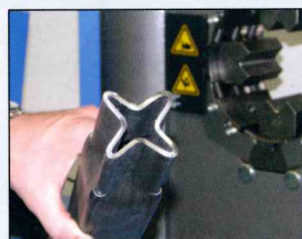
Формовка квадратных и круглых труб с помощью специальных кулачков
