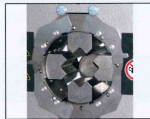
Формовка квадратных и круглых труб с помощью специальных кулачков
